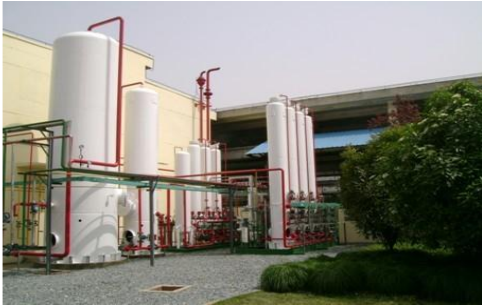
图 2-17：工业副产氢提纯装置
